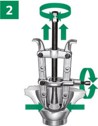
Funktionsprinzip eines zweiarmigen Abziehers
