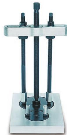
Abziehvorrichtung beim Ausbau von Zahnrädern
