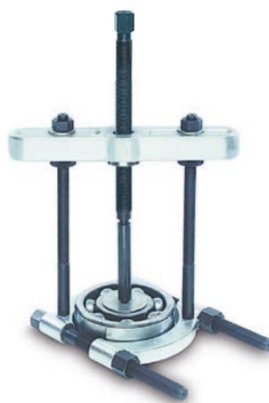
Trennvorrichtung beim Ausbau von Kugellagern
